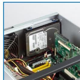
Stoßsicherer Einbauplatz für die 3,5" HDD
