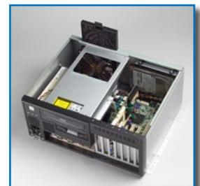
Massiver Laufwerkskäfig und leicht zu wartende Luftfilter
