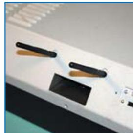
integriertes WLAN Modul (optional)
